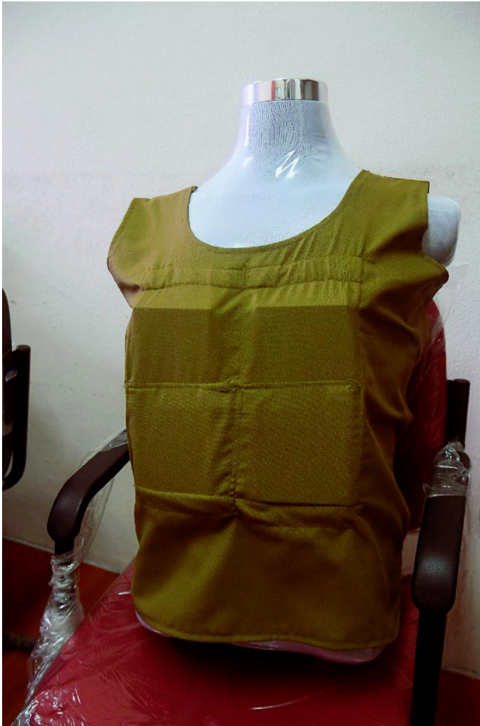
Jaket kalis peluru daripada lapisan helaian kulit bahagian pangkal pelepah kelapa ( cocos nucifera sheath ).
