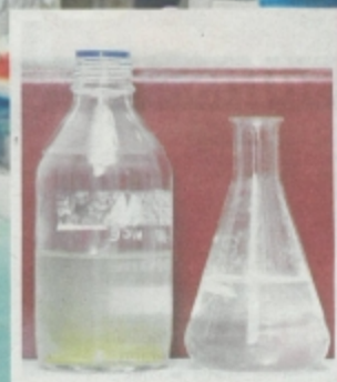
PERBEZAN air kotor (kiri) dengan air yang telah ditapis (kanan) menggunakan penapis mudah alih nano.
