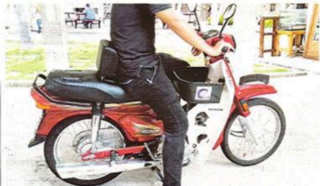
PENYANDAR kepala dalam kereta diubah suai menjadi 'Penyokong Ergonomik Lumbar' dan dipasang di tempat duduk penunggang dan pembonceng motosikal.
