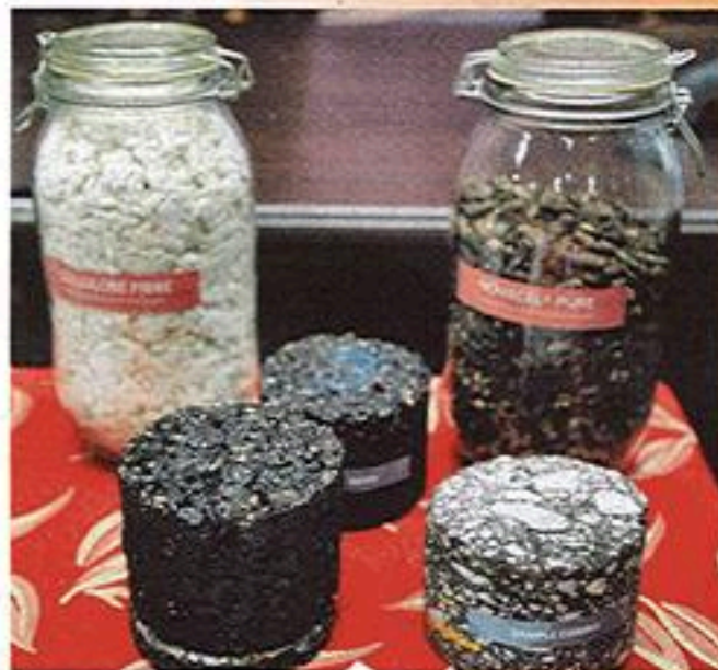
BAHAN untuk menghasilkan Fibre Mastic Asphalt (FMA).
