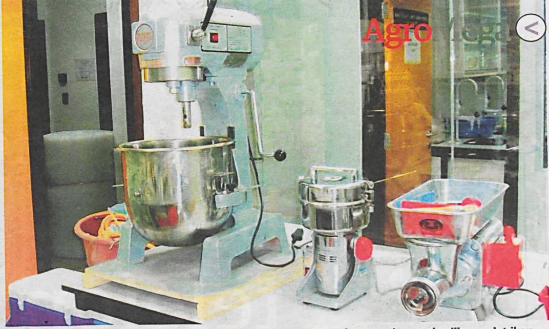
ALAT mencampur, mengisar dan membentuk yang digunakan untuk menghasilkan pelet ikan.
