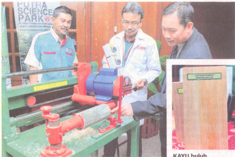
EDI Suhaimi Bakar (tengah) menerangkan kepada Ir Dr. Mohd. Saleh Jaafar (kanan) penggunaan mesin 'V-Grooving' untuk menjadikan buluh sebagai kepingan rata pada sidang akhbar di Kuala Lumpur, semalam.
