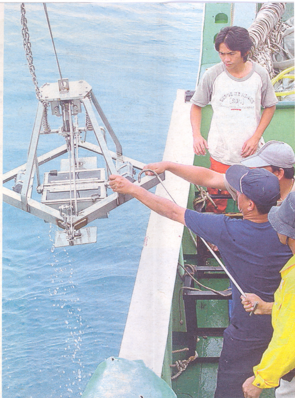
ALAT pengecuk sedimen yang digunakan untuk mengambil sampel dasar laut.
