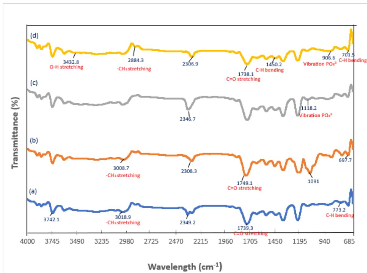
**Figure 2:** FTIR spectra of (a) pure PLA, (b) PLA/10FsHA, (c) PLA/30FsHA and (d) PLA/50FsHA
