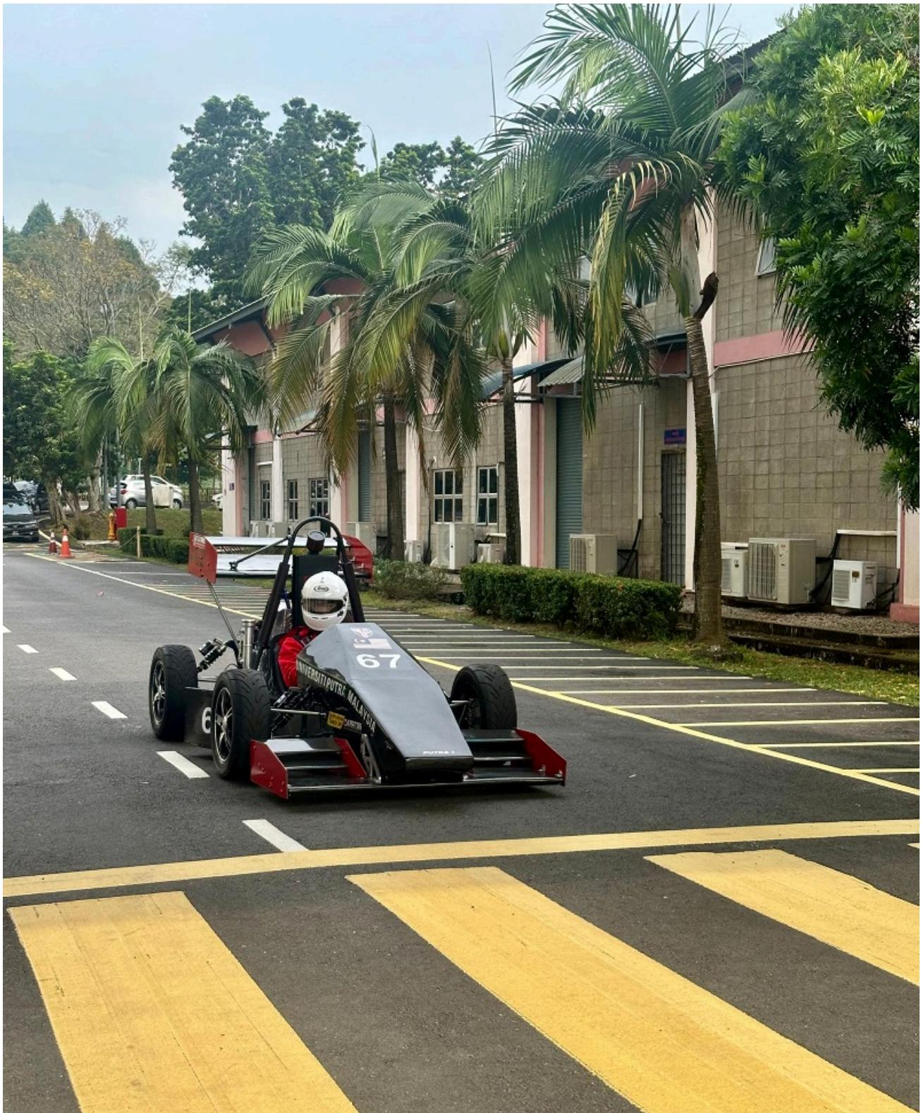
Kereta lumba UPM, Putra 1 telah dibangunkan dengan menggunakan enjin dari motorsikal Yamaha MT07 yang mempunyai kapasiti 689 cc menghasilkan kuasa sebanyak 75 hp pada 9000 rpm dan daya kilas sebanyak 68 Nm pada 6500 rpm.
